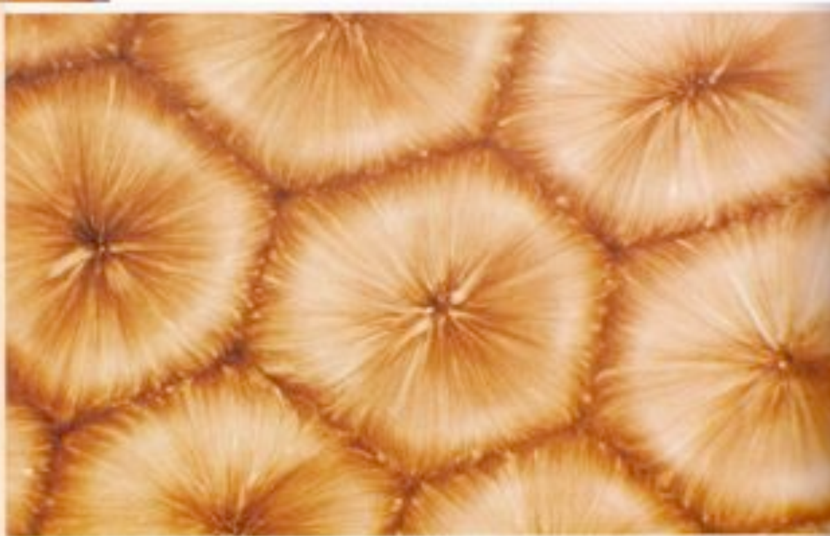
Veduta complessiva e ingrandimento dello schema esagonale di convezione in uno strato di olio silconico dello spessore di 1 millimetro.
